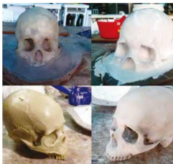
▲圖18. 左上：隔離處理；右上：澆淋矽膠；左下：不飽和聚脂半成品；右下：噴砂著色。
