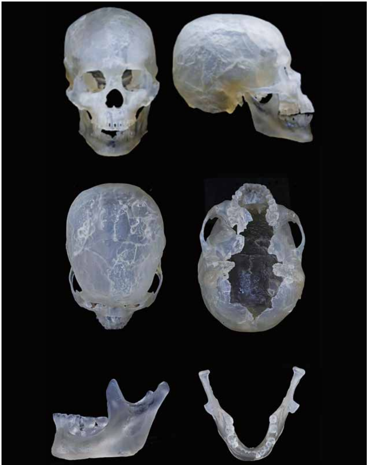
▲圖17. UV Curable Acrylic Plastic光硬化樹脂RP輸出「原型」之各角度。
