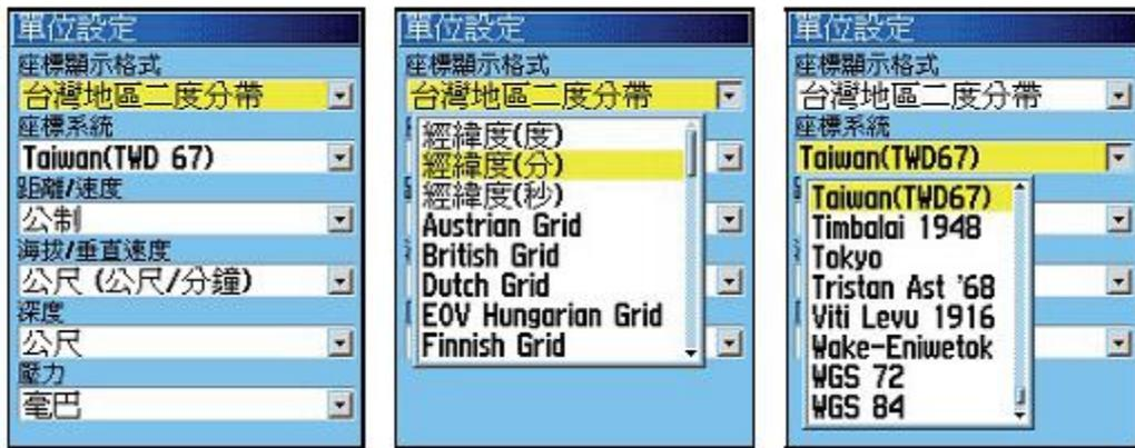
圖 2 GPS 坐標系統與投影坐標設定
