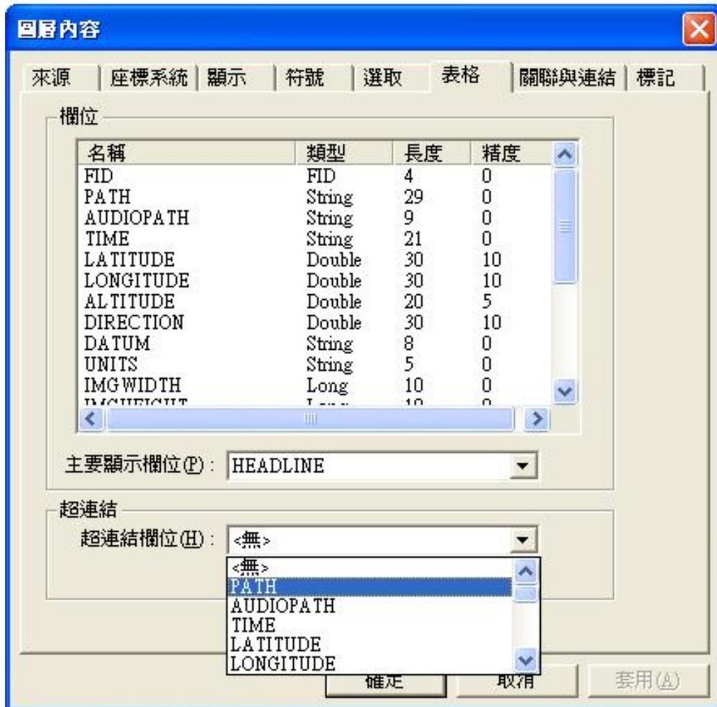
圖 29 於 SHP 屬性表中設定圖片超連結欄位
