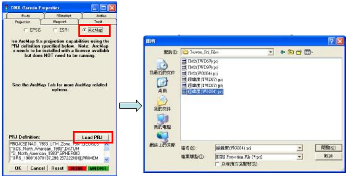
圖 35 選擇 WGS84 坐標系統定義檔
